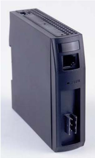
MODBUS 总线模块是 MLC 9000+多回路 PID 控制系统的一部分。该总线模块是 MLC 9000+ 系统中的管理员，用于管理与最多 8 个单回路或多回路模块以及 MODBUS RTU 网络的通讯。当构建大于 32 个回路的系统时，可以在 MODBUS RTU 系统支持的网络范围内使用多个总线模块。
