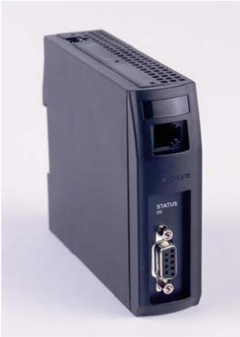
PROFIBUS 总线模块是 MLC 9000+ 多回路 PID 控制系统的一部分。该总线模块是 MLC 9000+ 系统中的管理员，用于管理与最多 8 个单回路或多回路模块以及 PROFIBUS 网络的通讯。当构建大于 32 个回路的系统时，可以在 PROFIBUS 系统支持的网络范围内使用多个总线模块。
