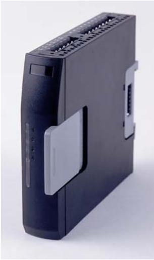
每个单回路模块都是一个独立 PID 控制器。可将最多 8 个回路模块连接到一个总线模块上。每个回路模块包含其自身的 PID 处理器以及所有输入和输出端子。MLC 9000+ 支持混合安装单回路和多回路模块。每个回路模块可在运行过程中被移除和更换（热插拔）。
