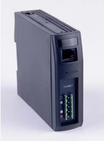
CANopen 总线模块是 MLC 9000+ 多回路 PID 控制系统的一部分。该总线模块是 MLC 9000+ 系统中的管理员，用于管理与最多 8 个单回路或多回路模块以及 CANopen 网络的通讯。当构建大于 32 个回路的系统时，可以在 CANopen 系统支持的网络范围内使用多个总线模块。
