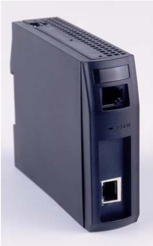
Ethernet/IP 总线模块是 MLC 9000+ 多回路 PID 控制系统的一部分。该总线模块是 MLC 9000+ 系统中的管理员，用于管理与最多 8 个单回路或多回路模块以及 Ethernet/IP 网络的通讯。当构建大于 32 个回路的系统时，可以在 Ethernet/IP 系统支持的网络范围内使用多个总线模块。
