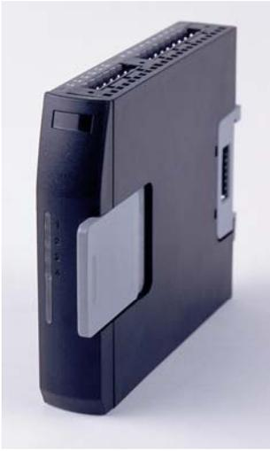
每个四回路模块都是一个带有 4 个输入和 6 个输出的独立的 PID 控制器。可以将最多 8 个回路模块连接到一个总线模块上，因此可具有多达 32 个独立控制回路。可以混合安装单回路、三回路和四回路模块。每个回路模块可在运行过程中被移除和更换（热插拔）。
