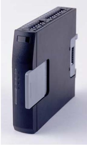
三回路 + 加热器断线检测模块是一个带有 3 个控制及加热器断线检测输入回路的独立的 PID 控制器。每个总线模块最多可以组态 8 个回路模块，因此可以具有全部带加热器断线检测功能的 24 个回路。可以混合安装单回路、三回路和四回路模块。每个回路模块可在运行过程中被移除和更换（热插拔）。
