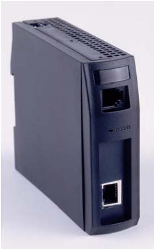
MODBUS/TCP 总线模块是 MLC 9000+ 多回路 PID 控制系统的一部分。该总线模块是 MLC 9000+ 系统中的管理员，用于管理与最多 8 个单回路或多回路模块以及 MODBUS/TCP 网络的通讯。当构建大于 32 个回路的系统时，可以在 MODBUS/TCP 系统支持的网络范围内使用多个总线模块。
